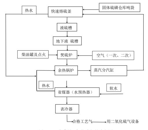
图 2.4-2 硫磺制二氧化硫气体流程图
